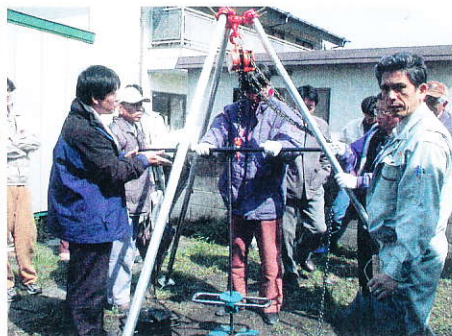
3月31日 地質調査（スウェーデン式サウンディング試験）実演講習
